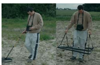
Détection avec le cadre et le disque 45 cm sur le SS 3100. Ce disque permet d'éliminer les objets en fer dans la plupart des cas
